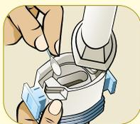
Após cada uso, limpe o bocal e o espaço vazio dentro do aparelho com pincel, cotonete, guardanapo de papel ou escovinha seca. Limpe a parte externa com pano seco.
